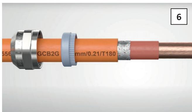
Il dado di compressione e l'inserto di tenuta vanno infilati sul cavo. Nota: l'inserto di tenuta è munito di fessura e può essere montato successivamente
